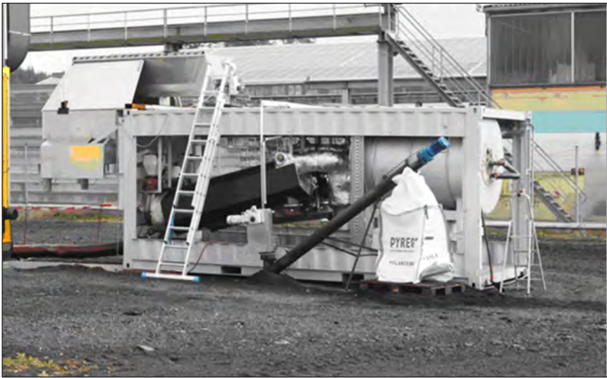
Abb. 47: Pilotanlage eines PYREG-Reaktors zur Herstellung von Biokohle aus Abfällen und Klärschlamm, Foto: J. M. Rödger 1)
