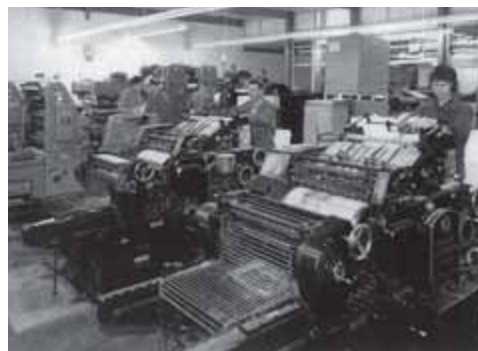
Blick in den Drucksaal ca. 1970. Vorn alte Hochdruck-Maschinen, im Hintergrund die ersten modernen Offset-Maschinen.
