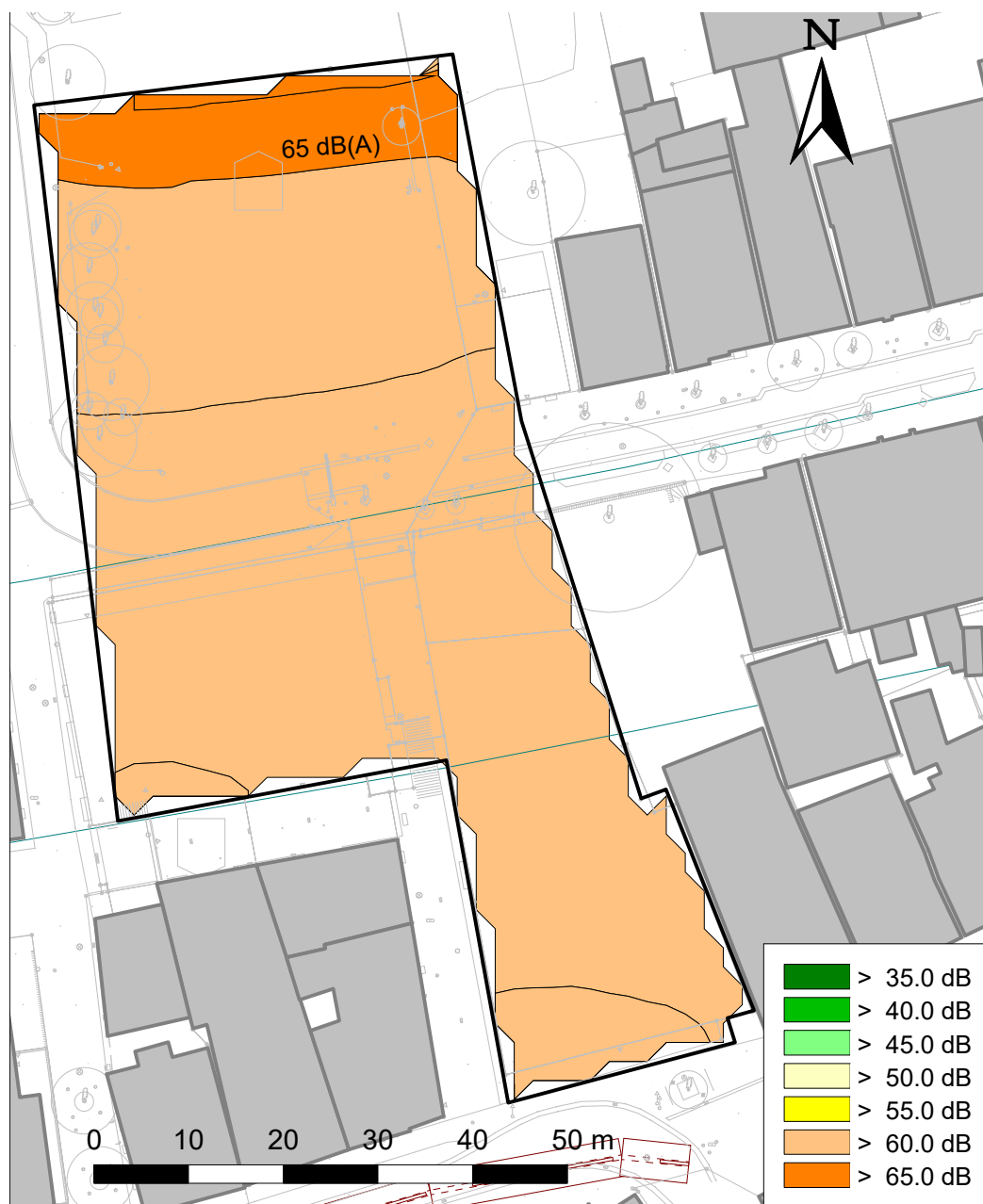
Abbildung 1: maßgeblicher Außenlärmpegel für schutzbedürftige Räume, Maßstab 1:750
