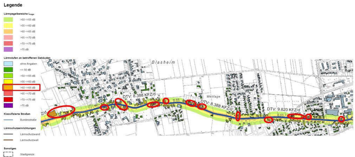
Abbildung 8: L_{\text{Night}} im westlichen Teil der B 65 bei Blasheim (Hauptstraße / Osnabrücker Straße)
